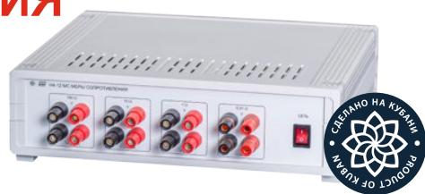
Мера сопротивления Н4-12МС с номинальными значениями сопротивлений 100, 10, 1 и 0,01 Ом изготовлена на основе прецизионных резисторов с низкой температурной зависимостью и очень малой частотной погрешностью. Технологические и конструктивные решения изготовления мер сопротивления обеспечивают сохранение частотных характеристик в течение всего срока эксплуатации.
