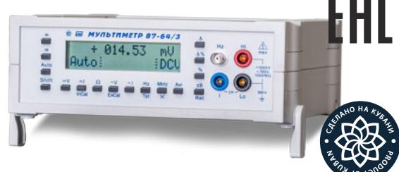
Мультиметр B7-64/3 (модернизированный вариант приборов B7-64, B7-64/1) предназначен для измерения постоянного и переменного напряжений, силы постоянного и переменного токов, сопротивления постоянному току, частоты. Прибор обеспечивает измерение среднеквадратического значения (СКЗ) сигналов переменного тока несинусоидальной
