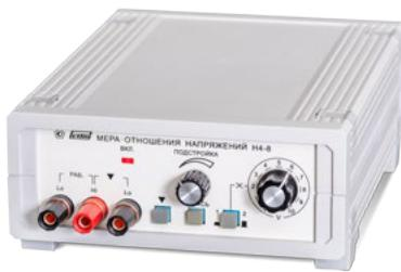
Мера отношения напряжений Н4-8 предназначена для определения линейности основных пределов вольтметров, аналого-цифровых преобразователей (АЦП), делителей и т.п., а также для расширения диапазона однозначных мер напряжения и э.д.с. Основу прибора составляет резистивная декада (десять последовательно соединенных равноточи-
