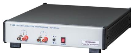
Преобразователь напряжение-ток Я9-44 обеспечивает преобразование постоянного и переменного напряжения (синусоидальной формы) до 30 В в силу тока до 30 А (соответственно постоянного и переменного) с коэффициентом преобразования 1 В / 1 А. При этом диапазону входных напряжений 0,1 мВ – 30 В соответствует выходной ток 0,1 мА – 30 А.
