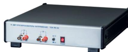
Преобразователь напряжение-ток Я9-44 обеспечивает преобразование постоянного и переменного напряжения (синусоидальной формы) до 30 В в силу тока до 30 А (соответственно постоянного и переменного) с коэффициентом преобразования 1 В / 1 А. При этом диапазоне входных напряжений 0,1 мВ – 30 В соответствует выходной ток 0,1 мА – 30 А.
