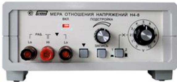
Предназначен для определения линейности основных пределов вольтметров, калибраторов, аналого-цифровых преобразователей, делителей и т.п., а также для расширения диапазона однозначных мер напряжения и ЭДС.
